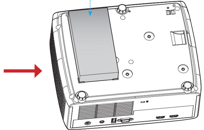
2. Sichern Sie das Netzteil mit dem Kabelbinder.
