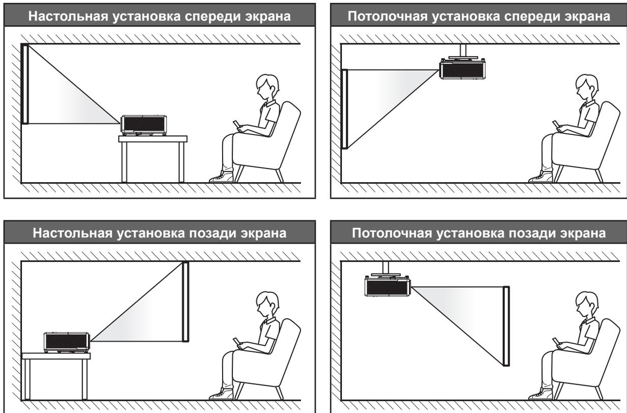
Проектор устанавливается на плоской поверхности и перпендикулярно экрану.
