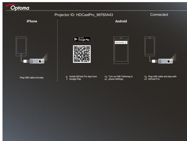
b) Conecte o projetor e o seu dispositivo inteligente com um cabo USB. A tela do seu dispositivo inteligente será automaticamente espelhada para o projetor.
